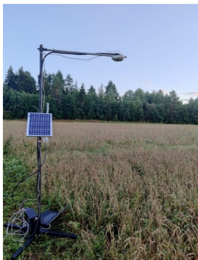
Рис. 30. Сенсорный узел, оснащенный оптическим датчиком для мониторинга состояния растительности
