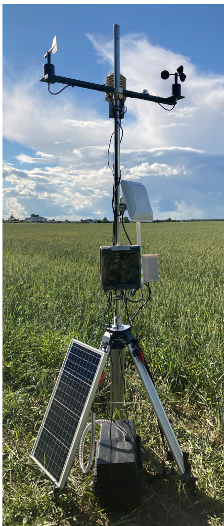
Рис.33. Базовая станция с интернет-каналом передачи данных для мониторинга метеорологических параметров
